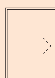
Κατασκευή ανοιγόμενη προς τα έξω
